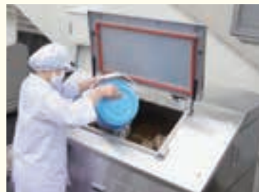
▲10月に設置した「食品残渣発酵分解装置」に給食の食べ残しを投入する様子
